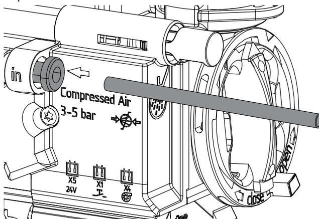
**i** Pour débrancher le tuyau flexible haute pression de la vanne de sélection de crachoir, il suffit de repousser le manchon noir du raccord d'air comprimé vers l'intérieur.
