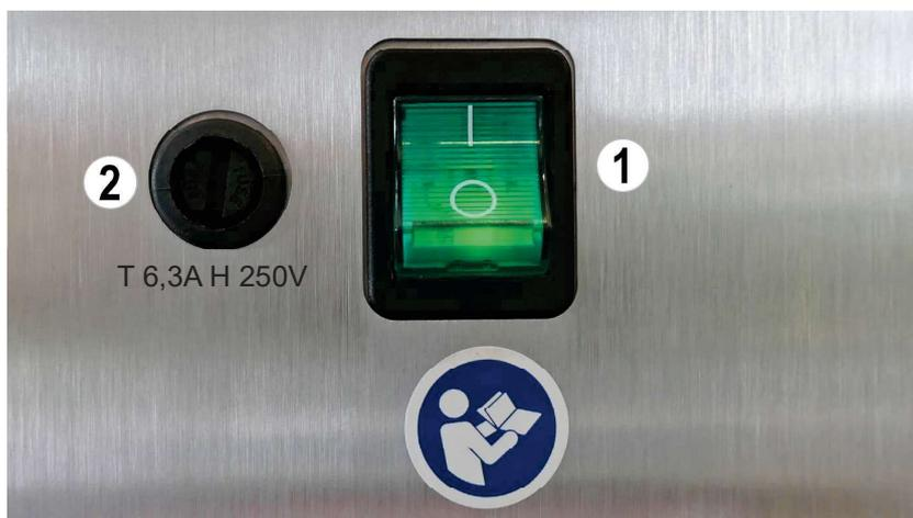
Le poste de traitement est équipé d'un interrupteur principal ① placé sur la base du fauteuil. L'interrupteur principal relie le poste de traitement au secteur.
